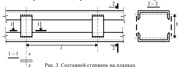
Рис. 3. Составной стержень на планках
